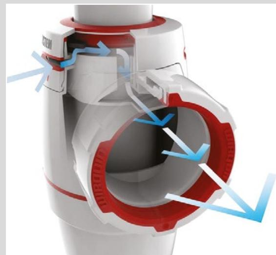
**WIRQUIN NEO AIR** позволяет естественно вентилировать трубы: когда давление в трубах понижается, мембрана открывается и создает постоянную вентиляцию, чтобы предотвратить всасывание воздуха и воды из гидрозатвора
