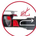
Силиконовая мембрана пропускает воду, но блокирует неприятные запахи
