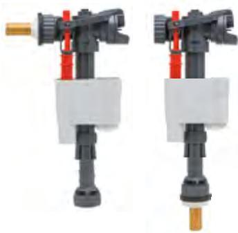
При выборе данного механизма обращайте внимание, что расстояние от стенки бачка до отверстия под заливной механизм должно быть не меньше 45 мм
